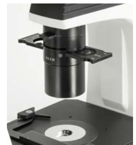
N. A. 0,3 Condensador Abbe con deslizador de contraste de fases
