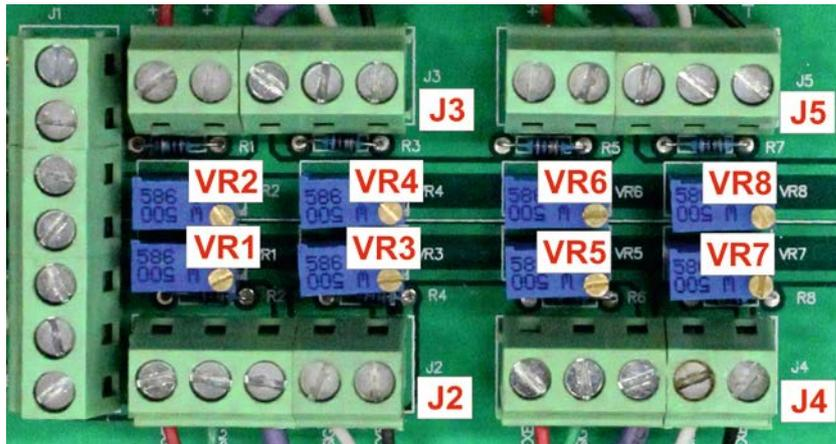
El ajuste de la célula de pesaje J2 se realiza mediante la potenciómetro VR1 y VR2.
