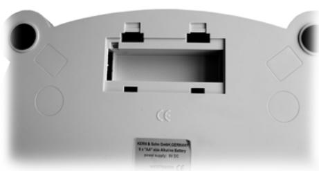
2. Zwischenboden durch verschieben und heraushebeln entfernen
