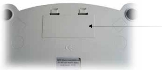
1. Batteriefachabdeckung entfernen
