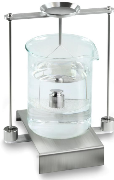
Fig. 2: Pesagem no líquido ensaiado
