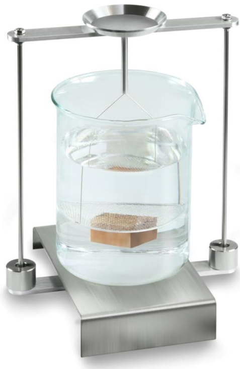
Ilustr. 4: Pesagem no líquido auxiliar
