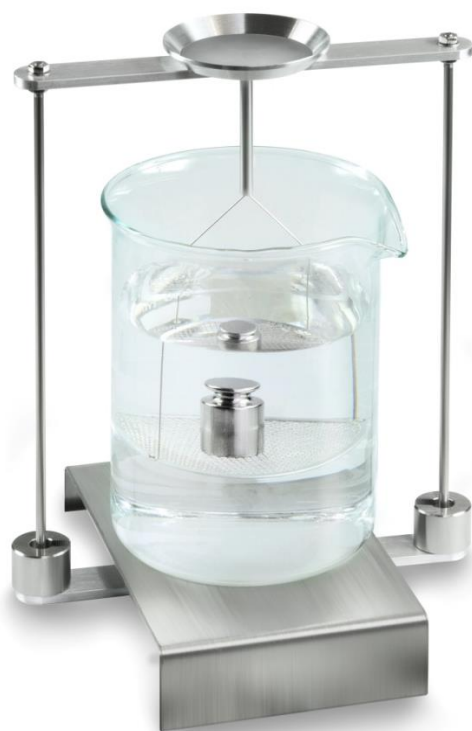
Ilustr. 2: Pesagem no líquido auxiliar
