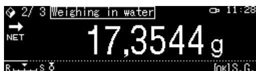
Fig. 2: Pesagem no líquido auxiliar
