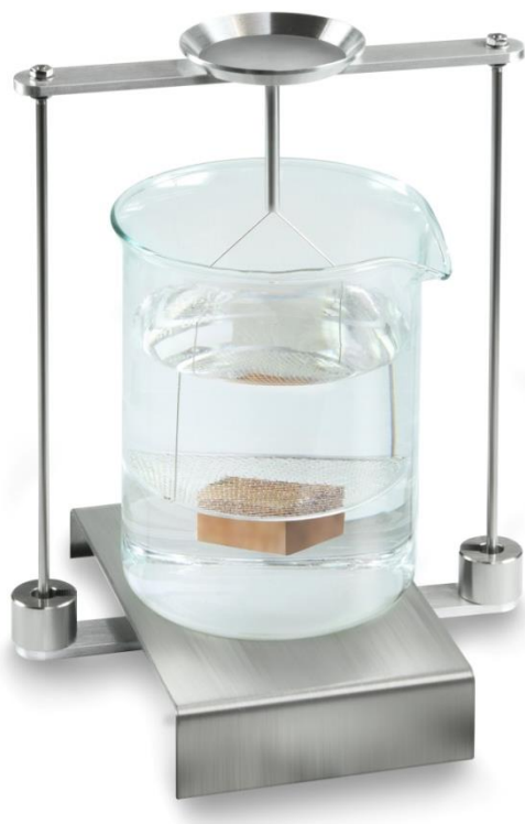
Fig. 4: Pesagem no líquido auxiliar
