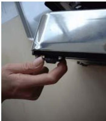
Die Waage mit Fußschrauben nivellieren, bis sich die Luftblase in der Libelle im vorgeschriebenen Kreis befindet.
