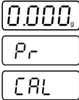
È possibile selezionare il peso di calibrazione dai quattro valori nominali predefiniti (circa 1/4; 1/2; 3/4; Max.). Al fine di ottenere i risultati più vantaggiosi dal punto di vista della tecnica di misurazione, si consiglia di selezionare possibilmente il più grande valore nominale.
