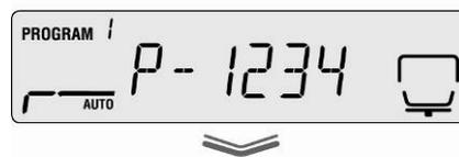
⇒ Confirmar mediante la tecla **ENTER**. Aparece el mensaje „**SET**” y a continuación „**PASS**”.
