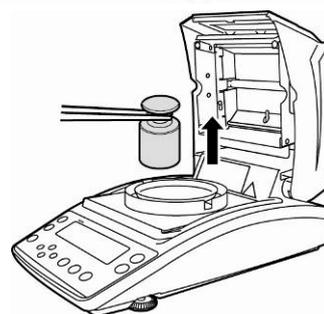
⇒ El ajuste concluye tras la aparición del mensaje "END". El aparato vuelve automáticamente al menú.
