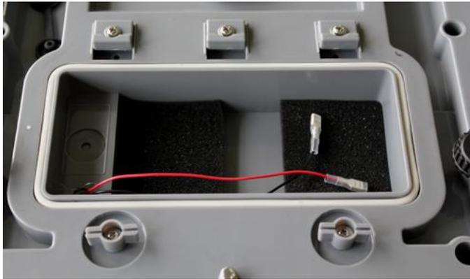
⇒ Retirer le couvercle du compartiment de l'accu et les cales en mousse synthétique
