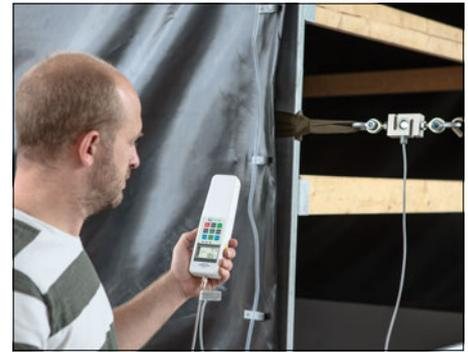
Medidor digital universal de fuerza para mediciones de fuerza en tracción y en compresión con célula de carga externa
