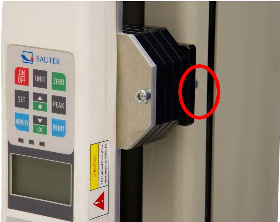
Ahora puedes montar la abrazadera de tornillo en el medidor de fuerza (aquí AE 500, marca roja).
