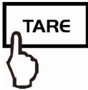
⇒ Waage entlasten und **TARE**-Taste drücken, die Nullanzeige erscheint.
